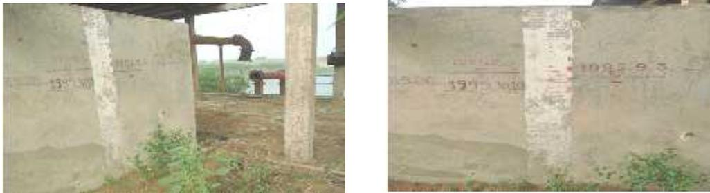
*Photo 2 : Llimnimètre installé en amont sur le fleuve mono à Dévé dans la commune de Dogbo (département du couffo) par la DGEau*
