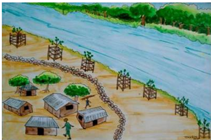
Th3 – 9 : la mise en place de diguettes, le reboisement, la reconstitution des berges et la protection des habitations
