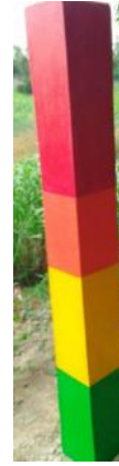
Balise de suivi du niveau de l'eau installé par le projet PSL Eau dans le cadre de l'implémentation du Système d'Alerte Précoce Communautaire à Zè.
